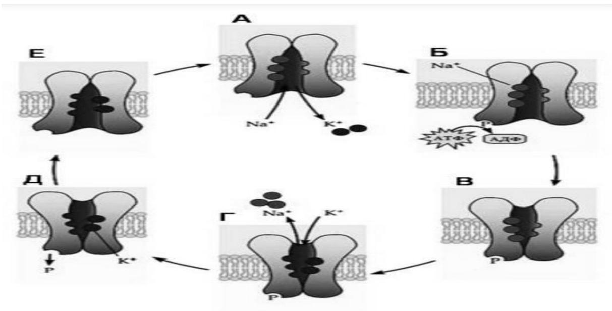
3. Потенциал покоя есть разница электролитических потенциалов, обнаруживаемых между внутренней и наружной поверхностями мембраны в невозбужденном состоянии. Потенциал покоя определяется разной концентрацией ионов. Укажите на схеме направление движения ионов.
