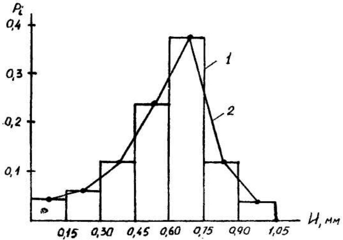
Рисунок 1 - Гистограмма (1) и полигон (2) распределение износов шлицев
