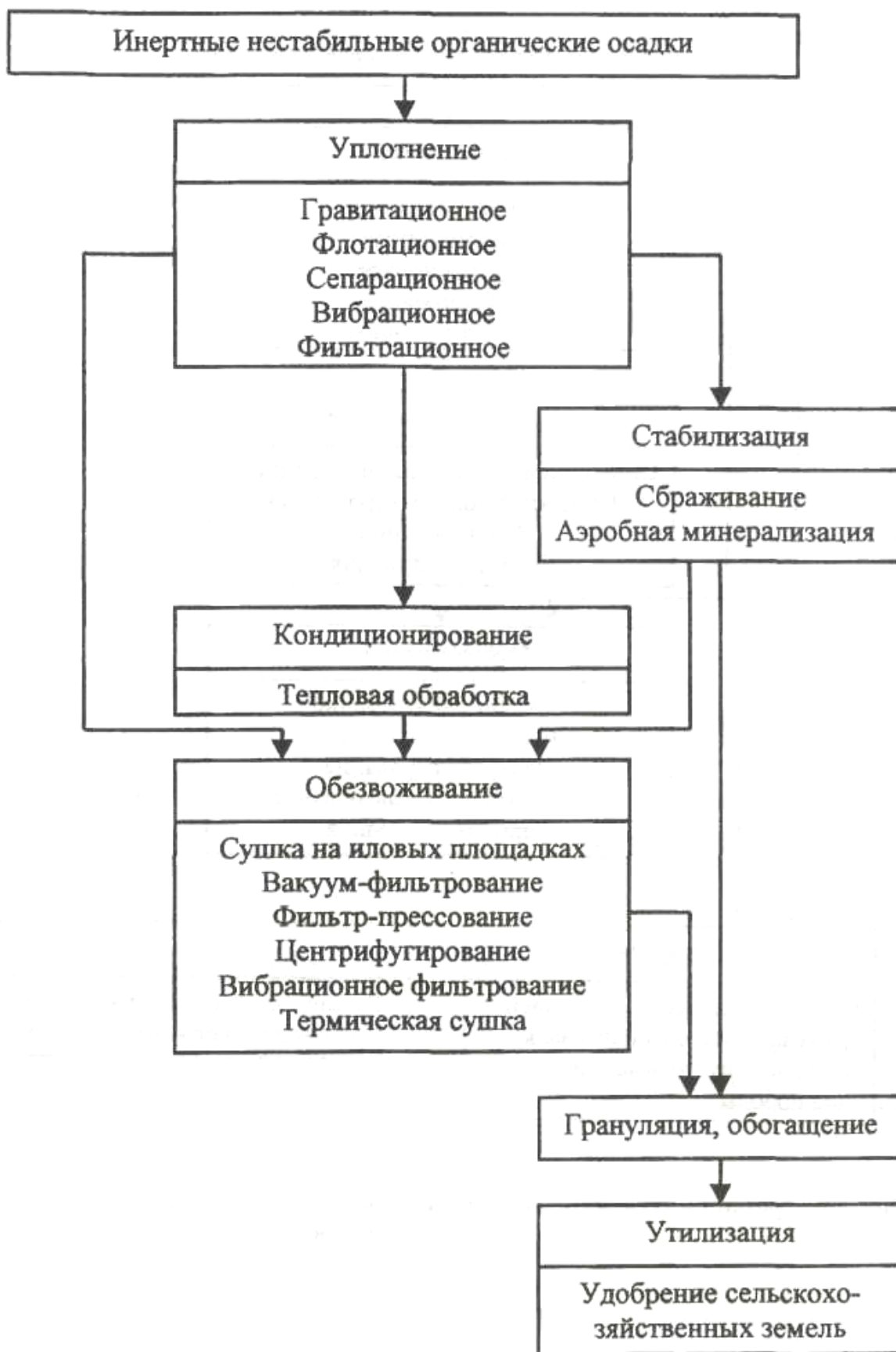
Рис. 15. Принципиальная схема системы обработки инертных нестабильных органических осадков
