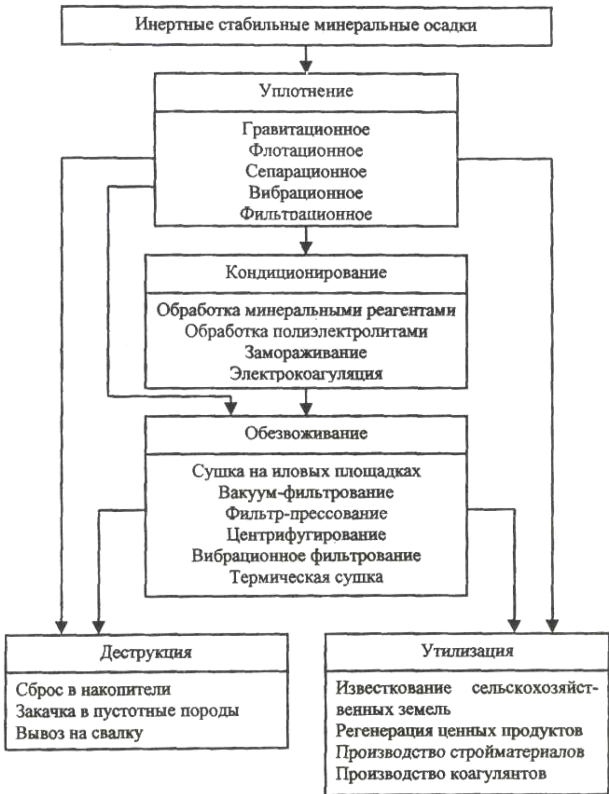
Рис. 16. Принципиальная схема системы обработки инертных стабильных минеральных осадков
